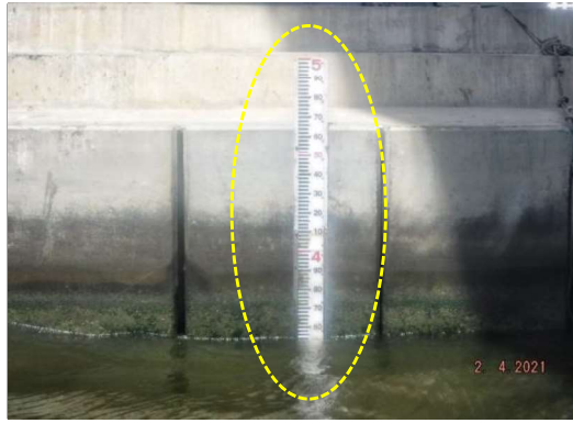
รูปที่ 2-6 การติดตั้งบรรทัดน้ำบริเวณแม่น้ำเจ้าพระยา
